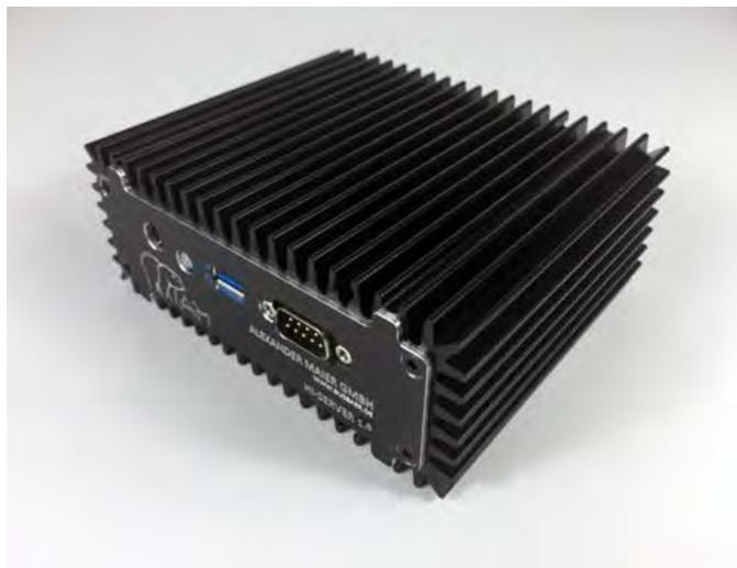
Durch seine kompakte Größe eignet er sich aber auch ideal für Digital-Signage-Anwendungen, denn er ist mit gut 5cm so schmal, dass er sich hinter jedem Monitor verstecken lässt oder als Stand-Alone-System verbaut werden kann. Der HI-Server spielt problemlos 1080p Inhalte ab und kann mit Hilfe einer erhältlichen VESA-Halterung sehr schnell und bequem hinter einen Monitor, auf einer Wand oder auf einer Hutschiene montiert werden – seine maximale Auflösung beträgt 3840 x 2160px.
