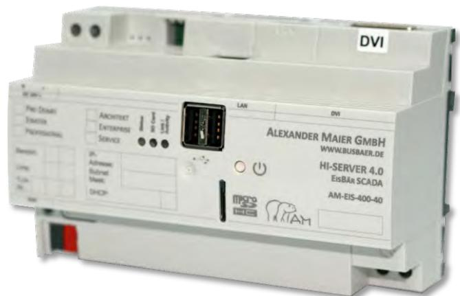
Die Verbindung zwischen dem HI-Server 4.0 und dem KNX-BUS lässt sich mittels interner Schnittstelle sehr einfach realisieren; eine zusätzliche Schnittstelle ist nicht mehr notwendig. Die interne Schnittstelle lässt sich im KNX-Treiber von EisBär SCADA direkt auswählen.
