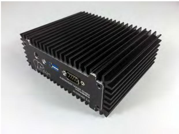
Die Verbindung zwischen dem HI-Server und der Anlage lässt sich mittels externer Schnittstelle sehr einfach realisieren. Wahlweise ist der Anschluss durch eine Netzwerkverbindung, zum entsprechenden EIB/KNX-Gateway (IP-Interface/IP-Router/ABB IG/S) oder über eine EIB/KNX-USB-Schnittstelle, möglich.
